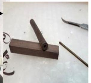
Integrazione e sostituzione dei tiranti interni di ferro con nuovi di ottone e rinforzi in legno
